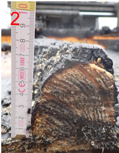
Bild A6.19: Restquerschnitt am zweiten Ständer: Feuerzugewandt: (ca. 0 mm) Feuerabgewandt: (ca. 60 mm).
