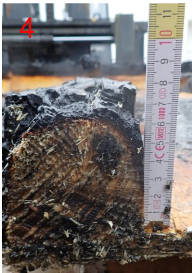
Bild A6.21: Restquerschnitt am vierten Ständer: Feuerzugewandt: (ca. 0 mm) Feuerabgewandt: (ca. 60 mm).
