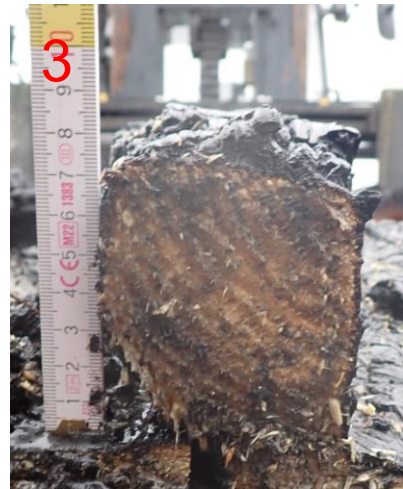
Bild A6.20: Restquerschnitt am dritten Ständer: Feuerzugewandt: (ca. 0 mm) Feuerabgewandt: (ca. 70 mm).
