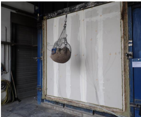
Bild A6.13: Prüfminute 92 – Zweite Schlagprüfung, Gipskartonplatten in der Probekörpermitte eingerissen, Mäßige Rauchentwicklung im Bereich der eingerissenen Gipskartonplatten.
