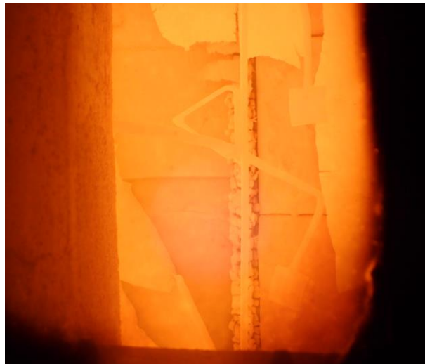
Bild A6.10: Prüfminute 74 – Sichtprüfung partiell wieder möglich, Gipsplatten fast vollständig abgefallen, Gefachdämmung ist sichtbar und partiell ausgefallen, Distanzhalter-Dämmung partiell ausgefallen.
