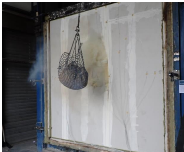
Bild A6.14: Prüfminute 94 – Dritte Schlagprüfung nach Lastreduzierung von 192 kN auf eine Klemmlast von 42 kN, starke Rauchentwicklung.
