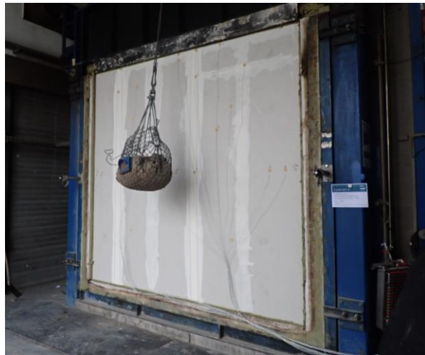
Bild A6.12: Prüfminute 92 – Erste Schlagprüfung, OF3 aufgrund der Schlagprüfung ausgefallen.
