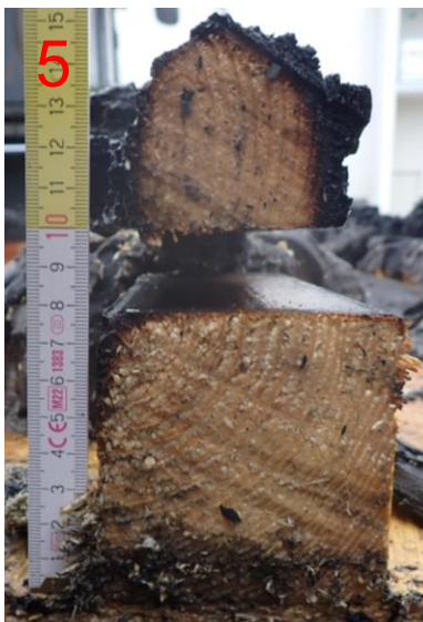
Bild A6.22: Restquerschnitt am fünften Ständer: Feuerzugewandt: (ca. 40 mm) Feuerabgewandt: (ca. 80 mm).
