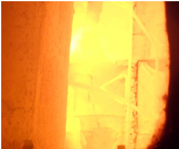
Bild A6.11: Prüfminute 80 – Die Gefachdämmung hinter der Distanzdämmung beginnt zu schmelzen.
