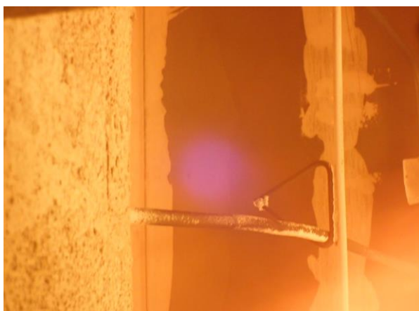
Bild A6.5: Prüfminute 4 – Die Papierschicht der Gipskartonplatten beginnt abzublättern.
