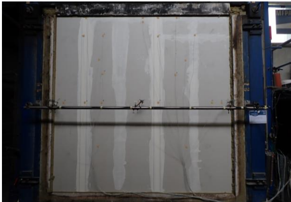
Bild A5.9: Blick auf die fertiggestellte dritte Plattenlage der Bekleidung / Beplankung der feuerabgewandten Wandseite B.
