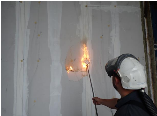
Bild A6.15: Prüfminute 94 – Anhaltende Flammenbildung, Raumabschlusskriterium nicht eingehalten, Ende der Feuerwiderstandsprüfung aufgrund Versagens des Raumabschlusses.
