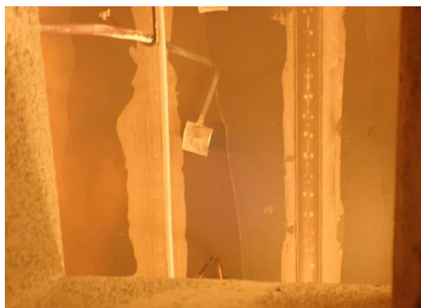
Bild A6.6: Prüfminute 7 – Die Gipskartonplatten sind vertikal eingerissen.
