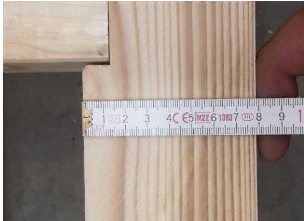
Bild A5.2: Blick auf die Einfräsungen der Schwelle und des Rähms (exemplarisch Schwelle).
