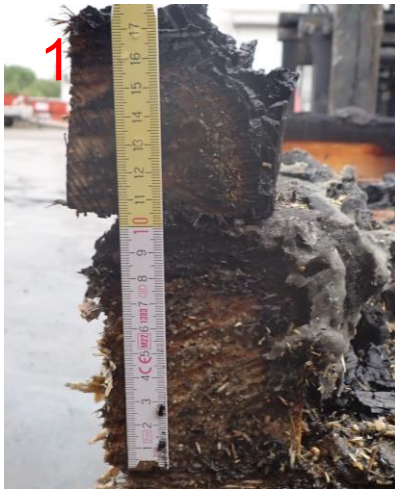
Bild A6.18: Restquerschnitt am ersten Ständer: Feuerzugewandt: (ca. 55 mm) Feuerabgewandt: (ca. 80 mm).
