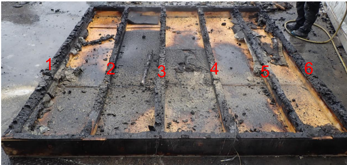
Bild A6.17: Blick auf den abgelöschten Probekörper; Reste der Gefachdämmung entfernt; Ständer (fortlaufend nummeriert) zur Dokumentation, Restquerschnitte ca. 750 mm von der Bauteilunterkante des Probekörpers aufgetrennt.
