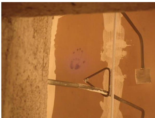
Bild A6.3: Prüfminute 1 – Probekörperoberfläche beginnt sich schwarz zu verfärben.
