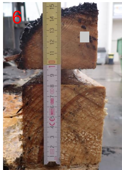
Bild A6.23: Restquerschnitt am sechsten Ständer: Feuerzugewandt: (ca. 45 mm) Feuerabgewandt: (ca. 80 mm).
