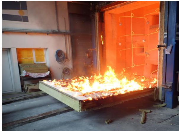
Bild A6.16: Prüfminute 96 – Entnahme des Probekörpers aus der Prüfeinrichtung
